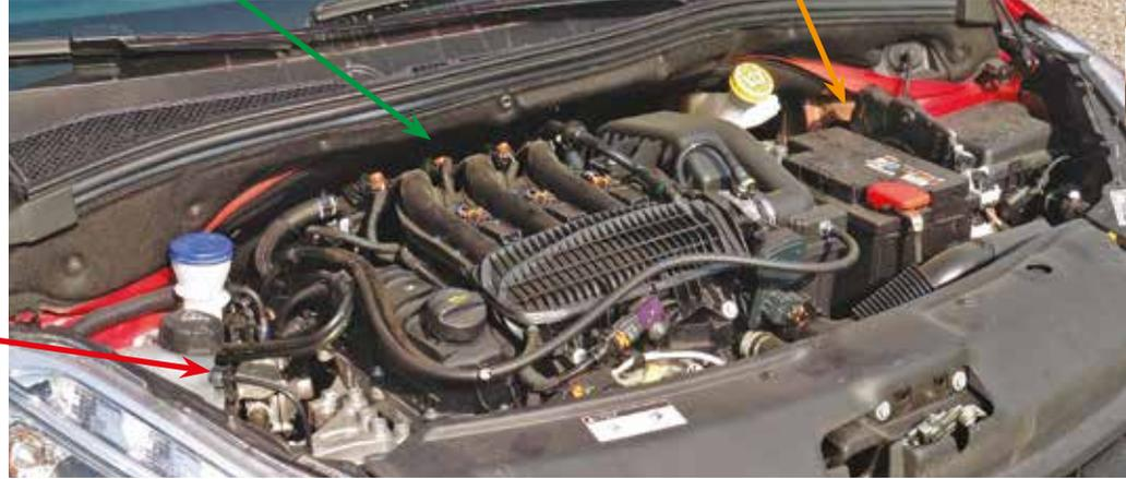
**Il 3 cilindri 1.2 da 82 CV ha testata, valvole e relative sedi ottimizzate per l'alimentazione a GPL e impianto di Landi Renzo montato in fabbrica.**
