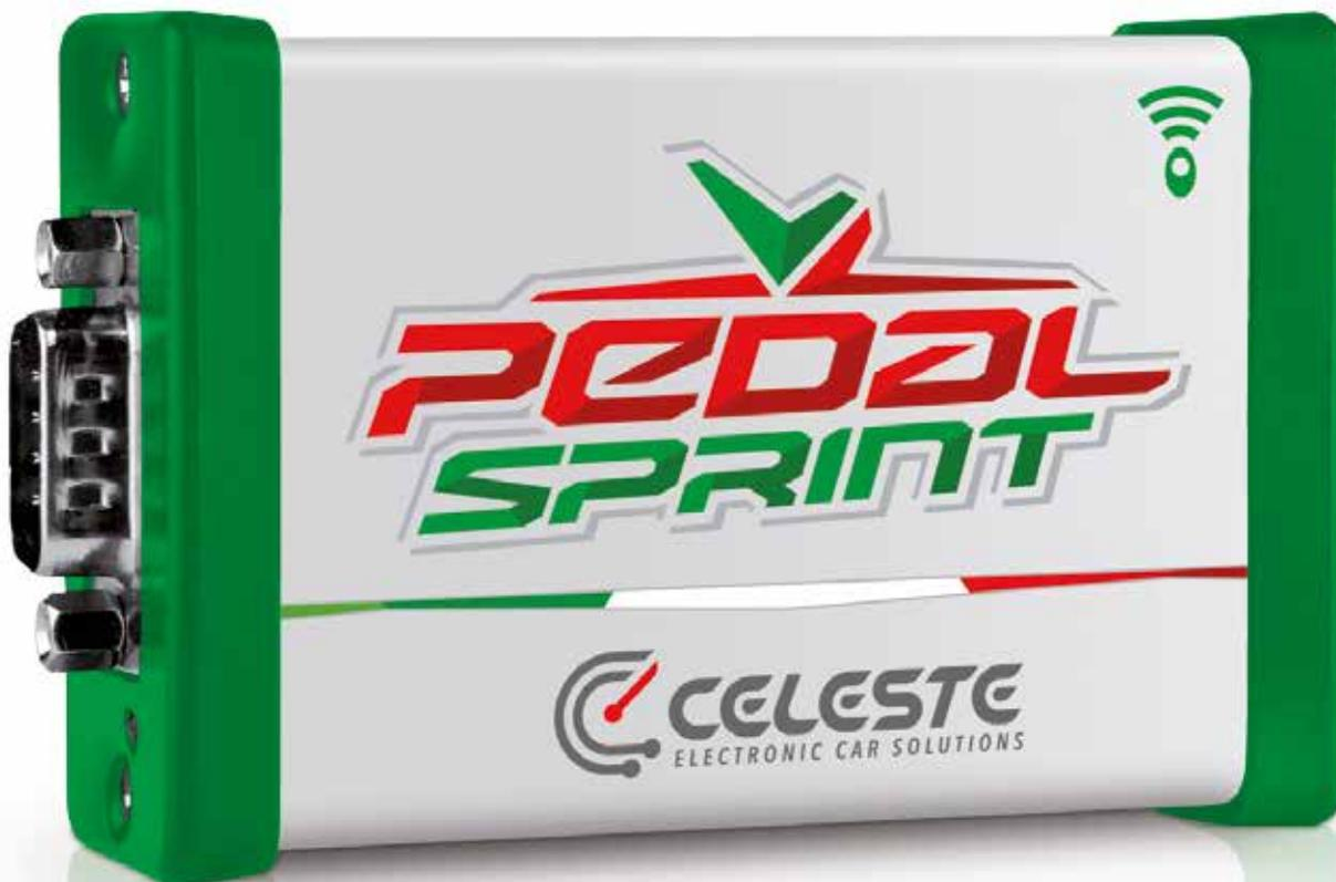
Il dispositivo Pedal Sprint si collega prima al connettore del pedale acceleratore, poi con il cavo USB al computer per regolare le funzioni con il software dedicato. Grazie al telecomando in dotazione sarà possibile decidere quando e come utilizzare il dispositivo.
