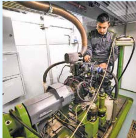
**Produzione di energia, il motore ES-3CB1-NG in prova al banco.**
